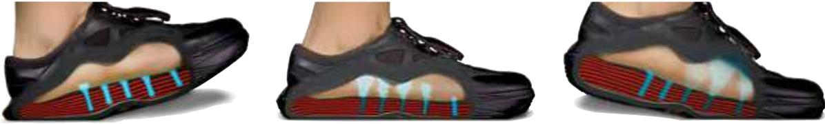
Die Abbildung zeigt schematisch die Dämpfung durch die Luftpolster mit zusätzlicher Belüftungsfunktion.
