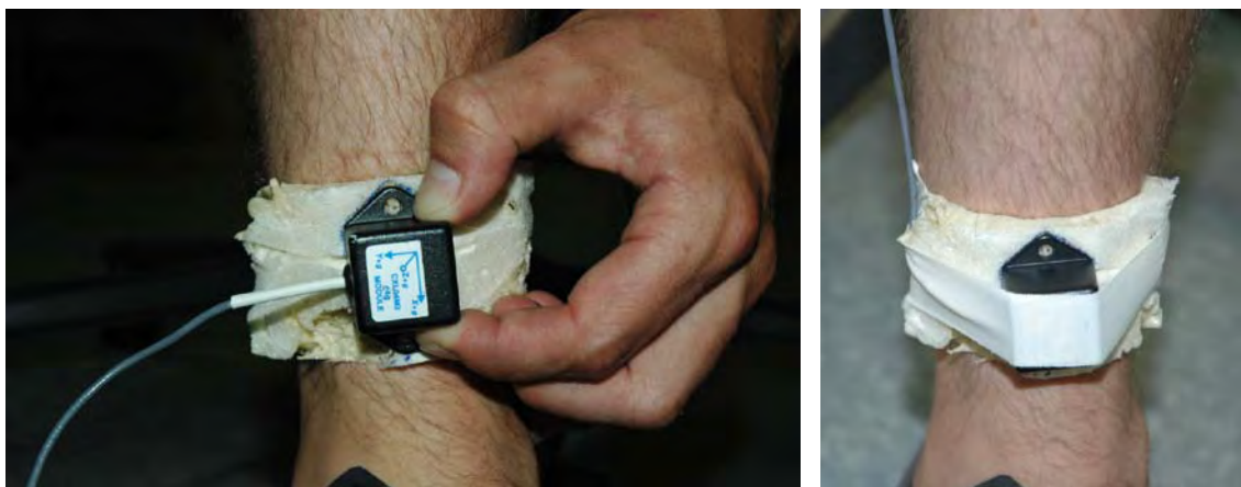
Abbildung 3: Befestigung des Beschleunigungssensors an der Tibia.
